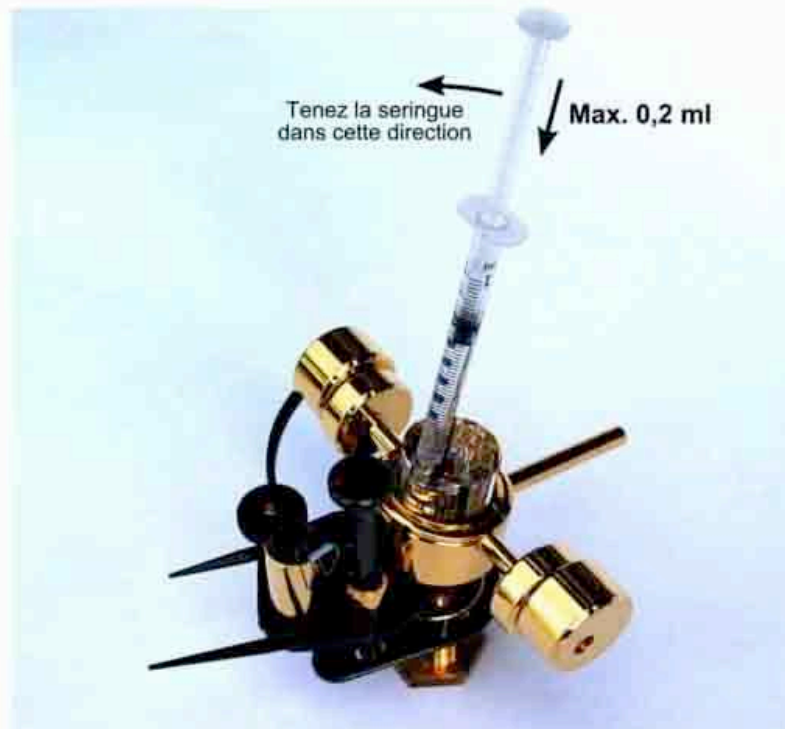
Fig. 9. L'amortissement du mode vertical de mouvement. Injecter max. 0,2 ml. Généralement aucun avantage.
