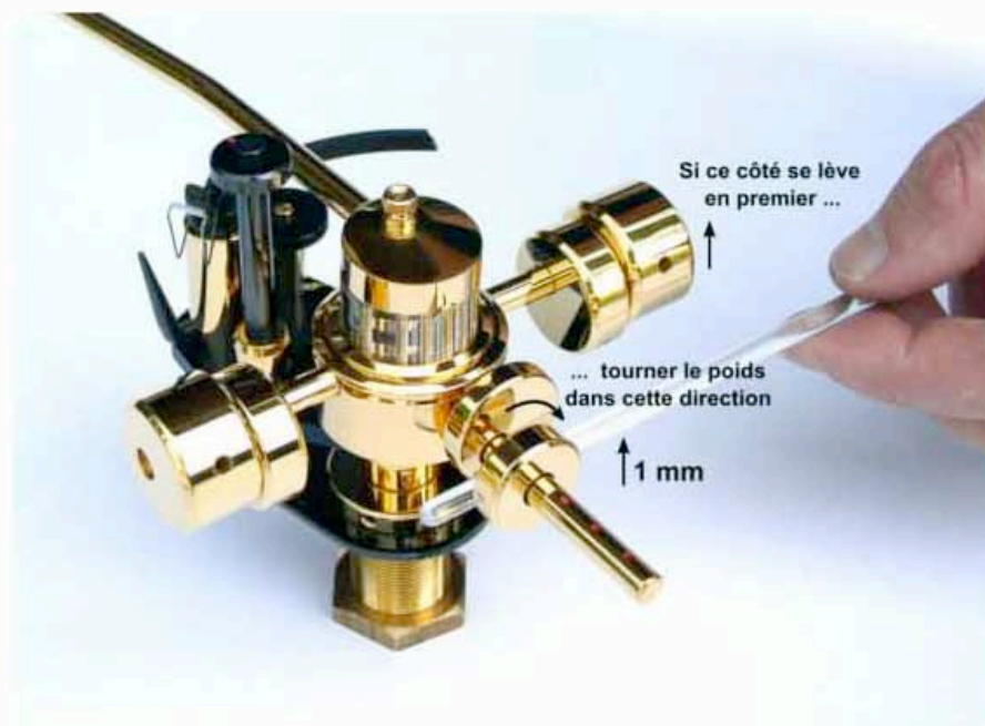
Fig. 12. Réglage fin en tournant la partie lourde du contrepoids du côté qui se déplace vers le haut en premier.
