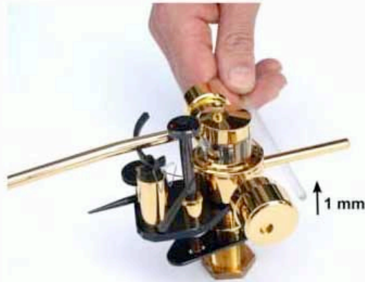
Fig. 7. En soulevant la tige du contrepoids de 1 mm, les poids des deux côtés doivent se soulever simultanément.
